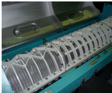
1 Eintragsbereich Füllkasten / 2 Verzahnungs-kupplung Antriebswelle Schnecke / 3 Siebstrecke mit geöffneten Abdeckhauben
